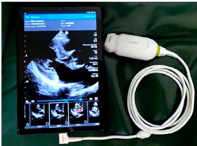
● Obrázek 2: Sondě lze připojit k příručnímu zařízení, mobilnímu telefonu nebo jako v tomto případě k tabletu.
